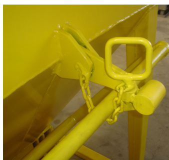
Fotos ilustrativas – Sistema duplo de segurança - Exemplo do equipamento em campo
